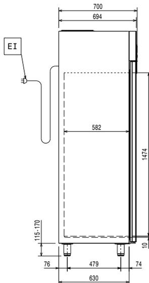
EI = Conexión eléctrica (energía)
